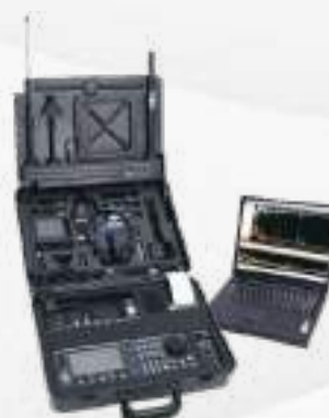
Equipamentos de Inspeção Eletrônica Ambiental (Detector de Junção não linear - ORION e Analisador de Espectro OSCOR)
